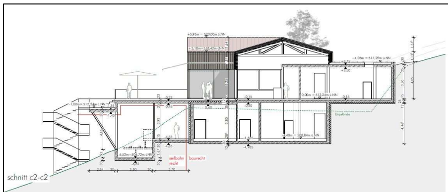
Schnitt Alm mit Bahnhof Wie-Li im Untergeschoss. Alm mit Gastraum und Sonnenterrasse im Erdgeschoss. Auskragend der RutschenEinstieg mit (Flucht)treppe.
